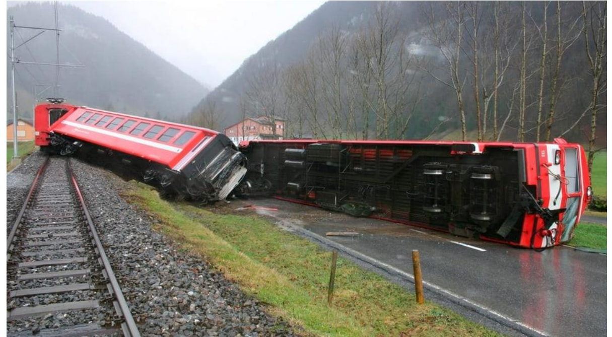
Sivutuuleen liitetty onnettomuus Sveitsistä vuodelta 2007 (M. Sprenger et al. 2018)
